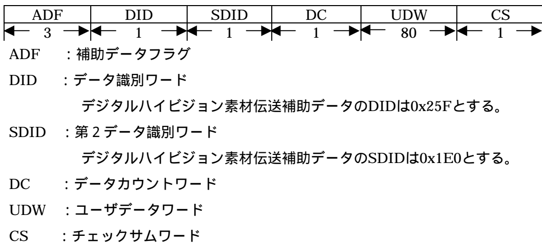
図5-1 デジタルハイビジョン素材伝送補助データパケットの構造 (数字はワード数を示す。以下同じ)
